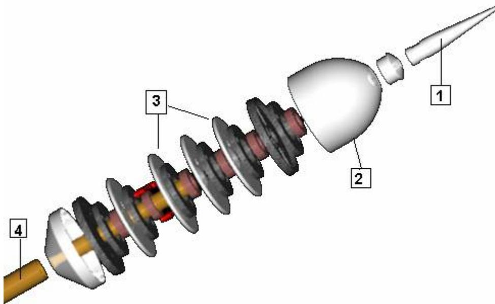
Gráfico 1. Detalles Cabezal de Pararrayos SCHIRTEC E.S.E.
